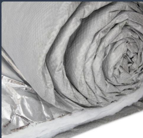
Tagliate con lo strumento più adatto, in base allo spessore del prodotto SuperFOIL, fissatelo sulle travi in legno del tetto spiovente, dalla trave di colmo al listello di gronda, utilizzando morsetti in acciaio zincato o inossidabile della dimensione corretta a intervalli di 300 mm.
